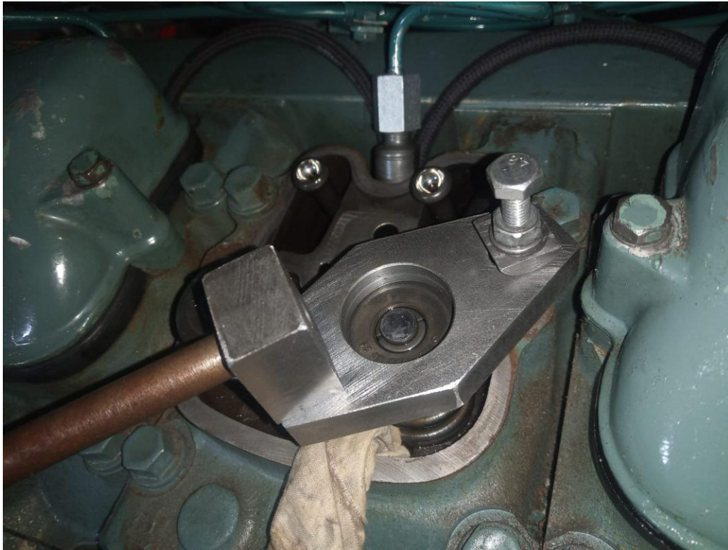
Bovenstaand het hulpgereedschap om de klepveren te verwijderen.
