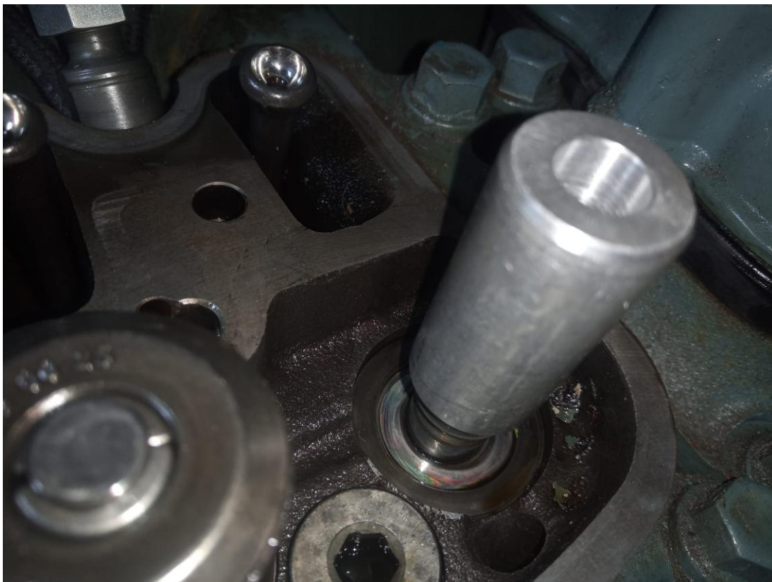
Bovenstaande een aluminium hulpgereedschap het net nieuwe seal op de plek te duwen zonder deze te beschadigen.
